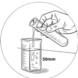
**Passo 7:** Transferir a amostra (cilindro 1) para cubeta de 50mm e realizar a leitura da amostra.
