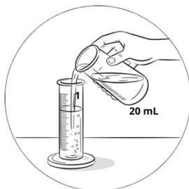
Medir 20 mL de amostra em cilindro graduado 1 com tampa.
